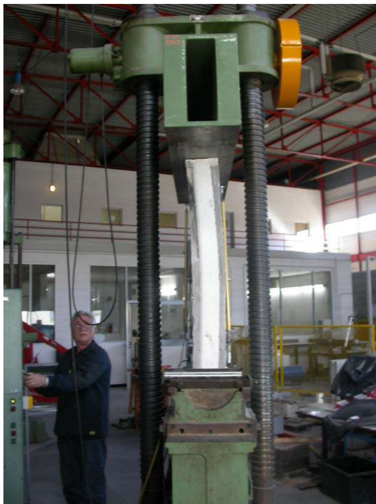
Figura 16: Instabilizzazione del provino
