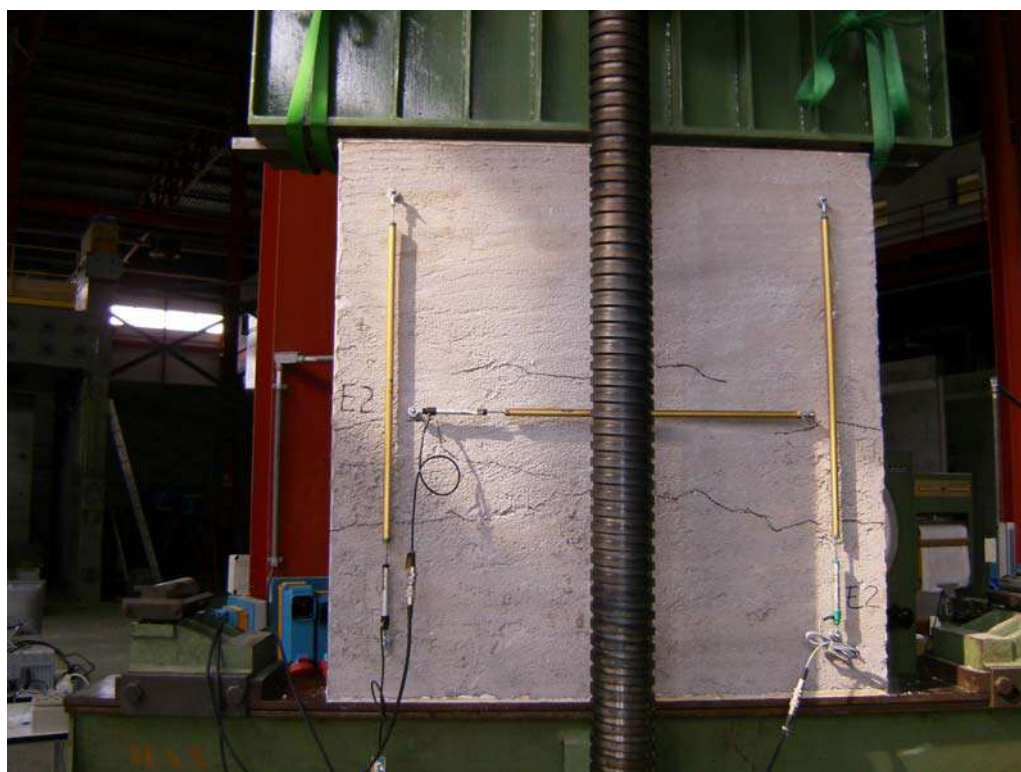
Figura 21: Quadro fessurativo durante la prova
