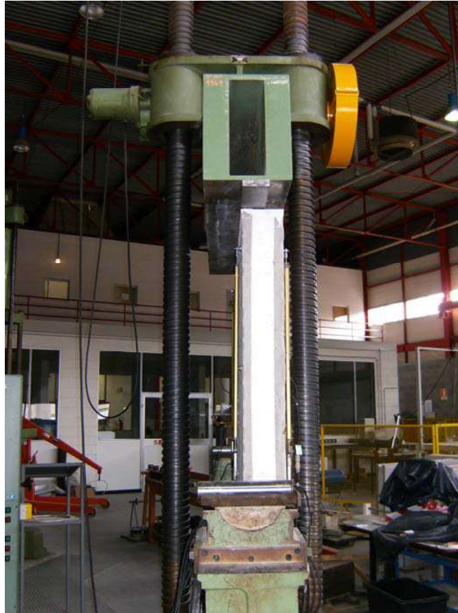
Figura 4: Prova di compressione eccentrica
