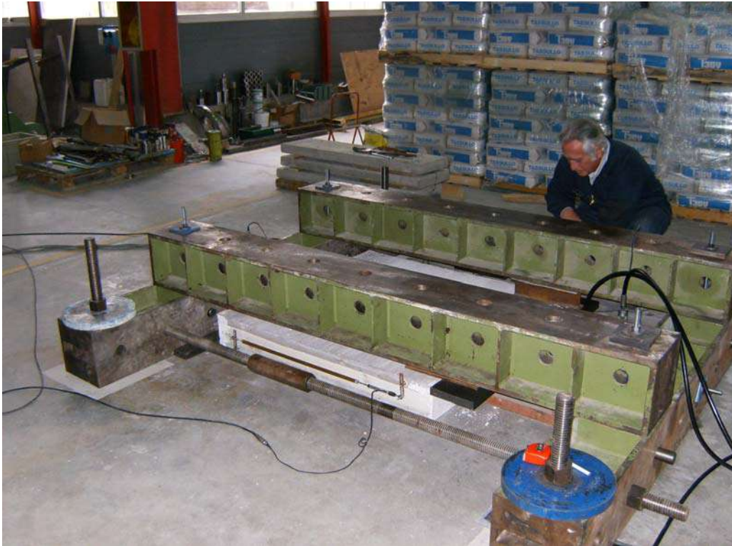
Figura 5: Prova di delaminazione
