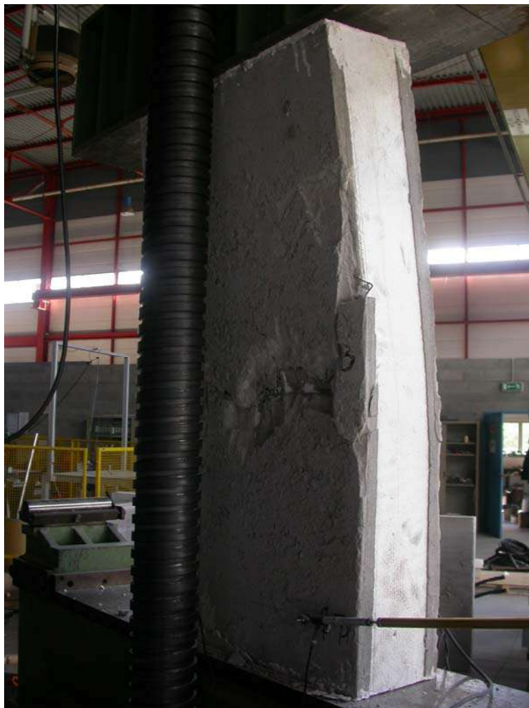
Figura 13: Rottura per pressoflessione
