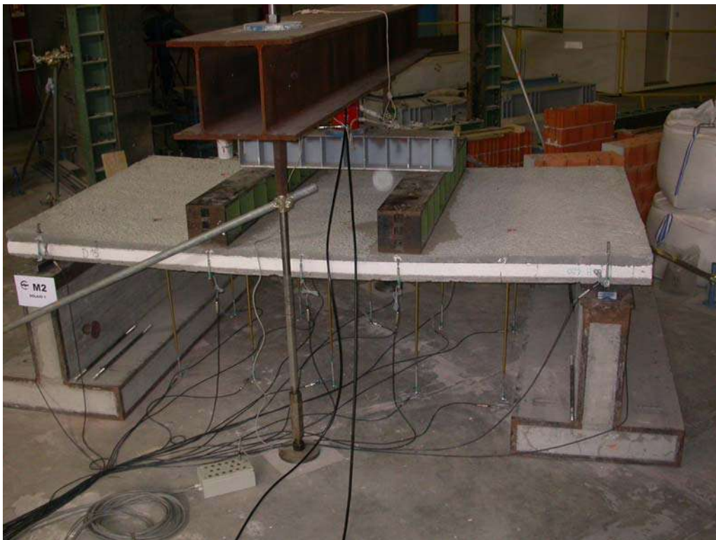
Figura 1: Solaio in configurazione di prova
