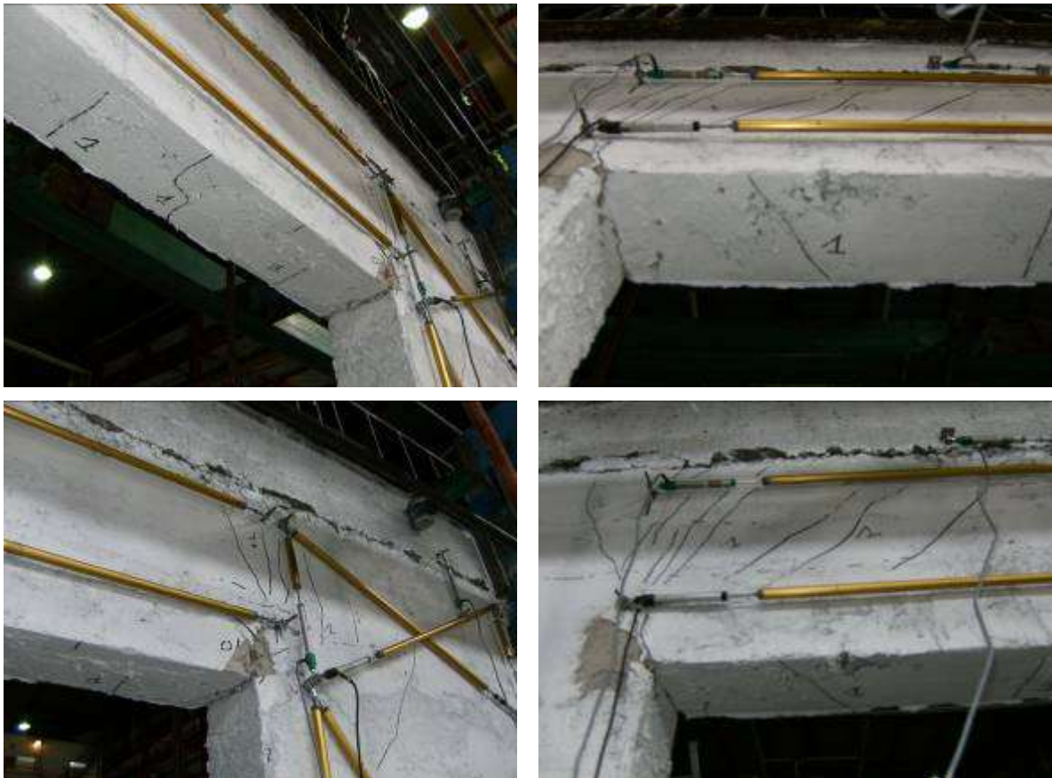
Figura 49 Danneggiamento al termine dell'imposizione dei tre cicli a livello di drift 0.6%
