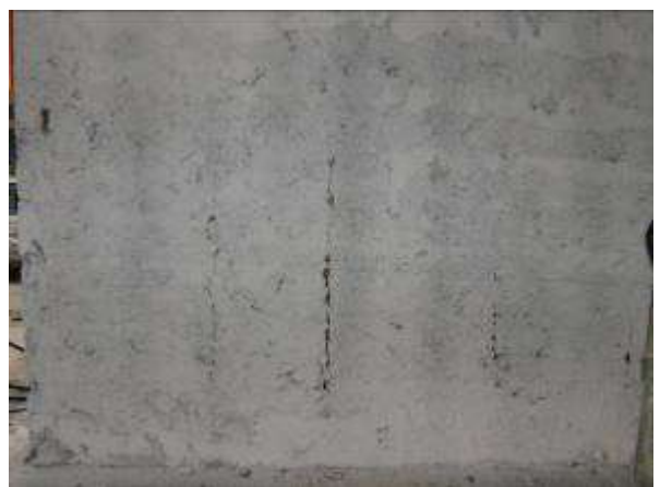
Figura 67 Danneggiamento al termine dell'imposizione dei tre cicli a livello di drift 0.6%
