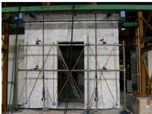
Figura 65 Danneggiamento al termine dell'imposizione dei tre cicli a livello di drift 0.2%
