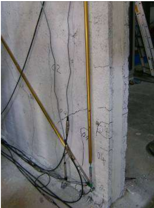
Figura 21 Danneggiamento al termine dell'imposizione dei tre cicli a livello di drift 0.4%
