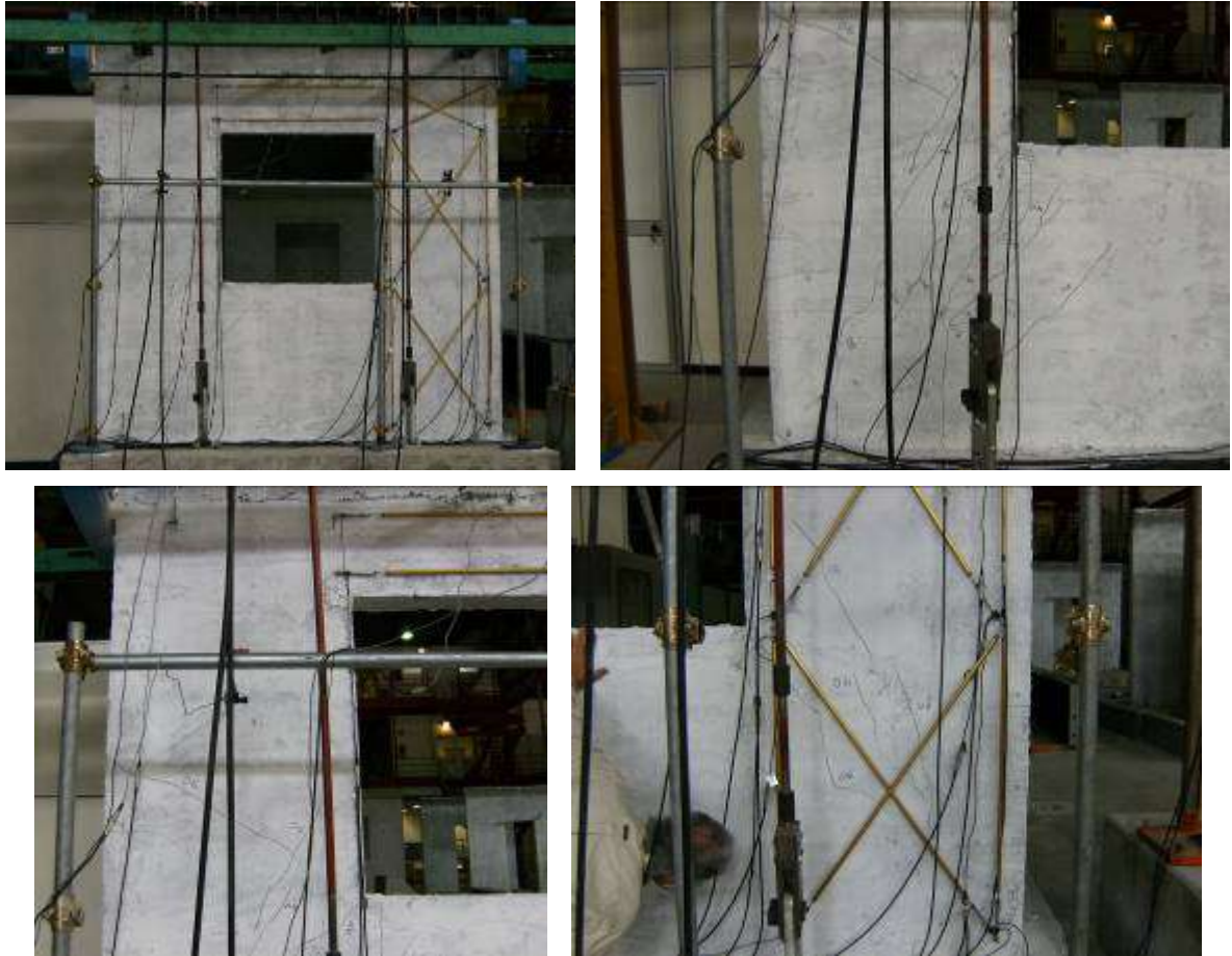
Figura 49 Danneggiamento al termine dell'imposizione dei tre cicli a livello di drift 0.6%
