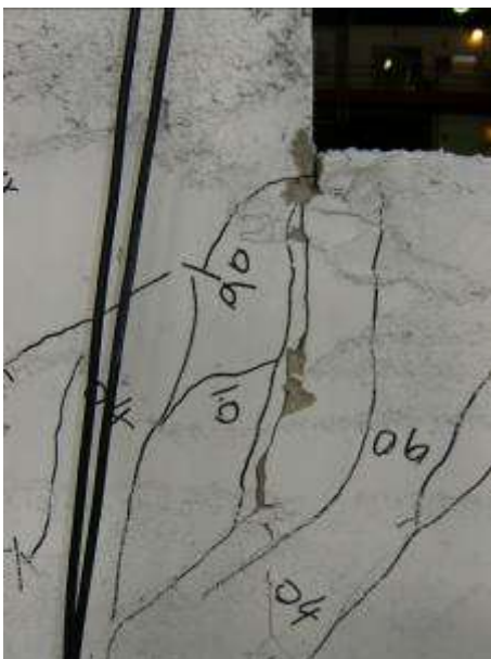
Figura 50 Danneggiamento al termine dell'imposizione dei tre cicli a livello di drift 1.0%
