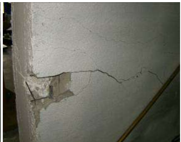
Figura 32 Danneggiamento al termine dell'imposizione dei tre cicli a livello di drift 0.4%
