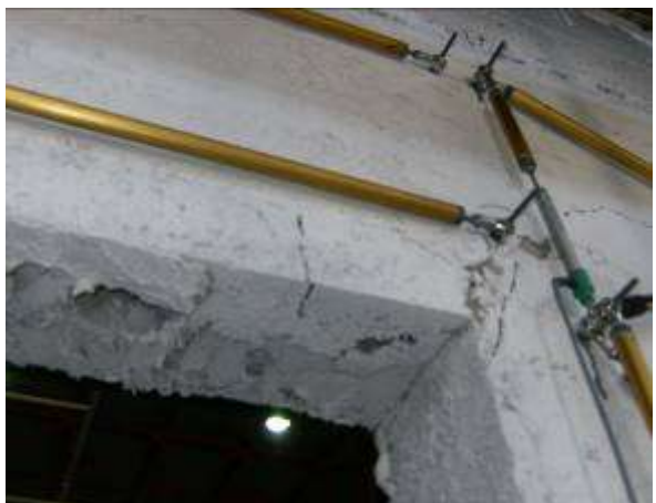
Figura 56 Danneggiamento al termine dell'imposizione dei tre cicli a livello di drift 0.6%
