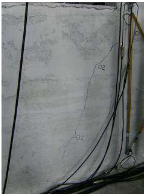
Figura 54 Danneggiamento al termine dell'imposizione dei tre cicli a livello di drift 0.2%
