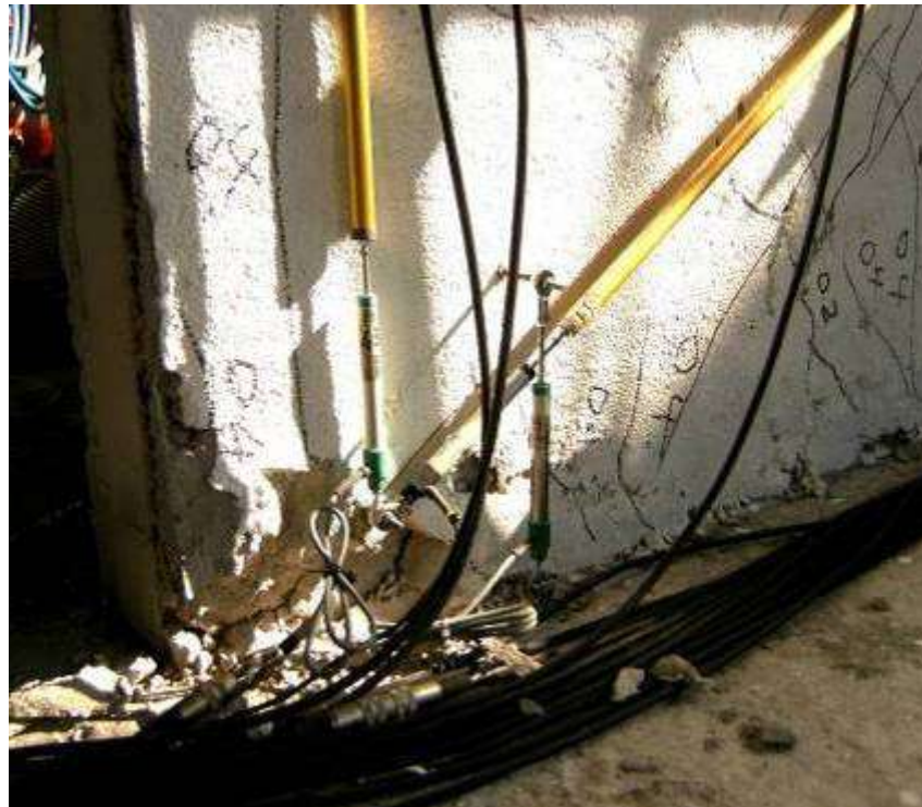
Figura 39 Danneggiamento al termine dell'imposizione dei tre cicli a livello di drift 0.4%
