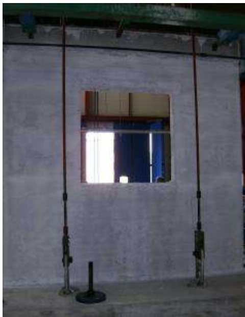
Figura 53 Danneggiamento al termine dell'imposizione dei tre cicli a livello di drift 0.1%
