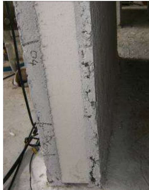
Figura 66 Danneggiamento al termine dell'imposizione dei tre cicli a livello di drift 0.4%
