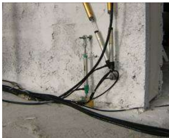
Figura 65 Danneggiamento al termine dell'imposizione dei tre cicli a livello di drift 0.2%
