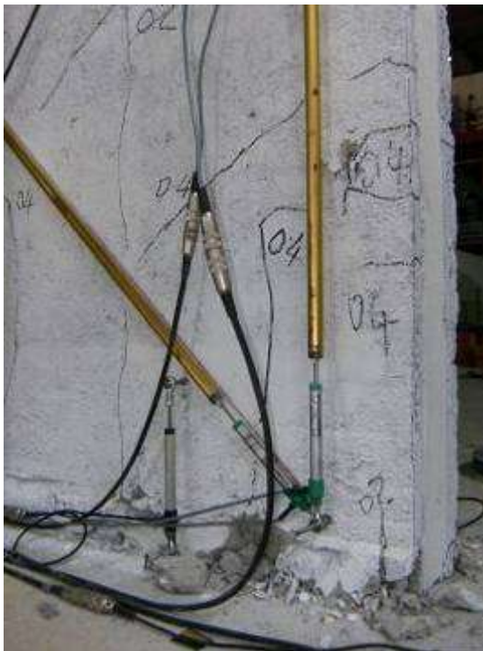
Figura 22 Danneggiamento al termine dell'imposizione dei tre cicli a livello di drift 0.6%
