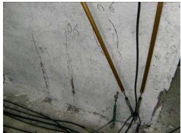
Figura 77 Danneggiamento al termine dell'imposizione dei tre cicli a livello di drift 0.6%
