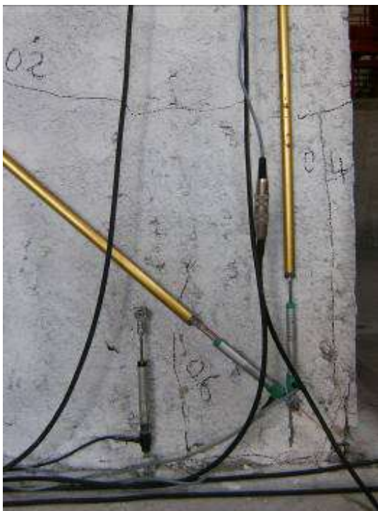
Figura 14 Danneggiamento al termine dell'imposizione dei tre cicli a livello di drift 0.6%: quadro fessurativo sulla facciata
