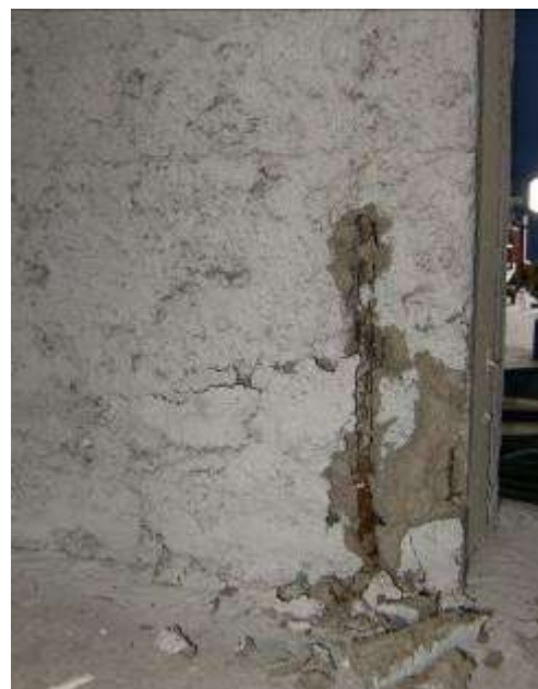
Figura 55 Danneggiamento al termine dell'imposizione dei tre cicli a livello di drift 0.4%
