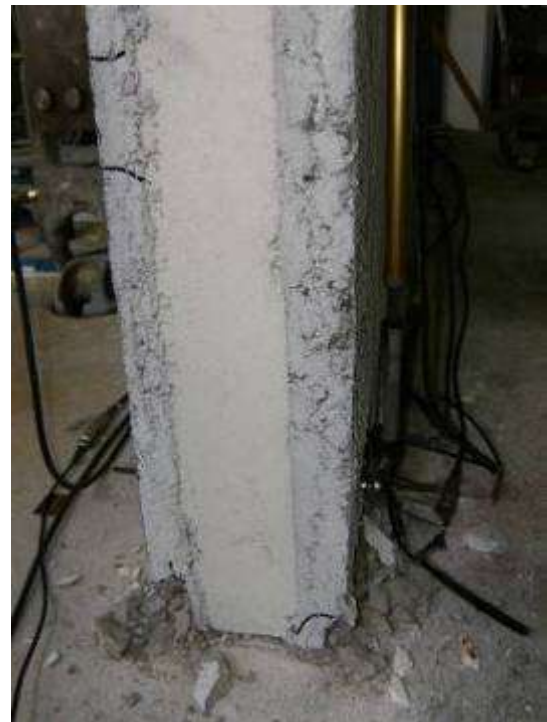
Figura 22 Danneggiamento al termine dell'imposizione dei tre cicli a livello di drift 0.6%
