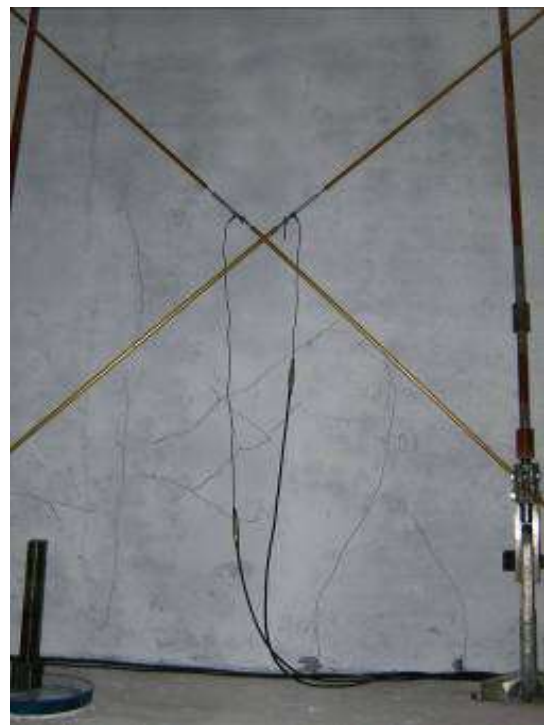
Figura 14 Danneggiamento al termine dell'imposizione dei tre cicli a livello di drift 0.6%: quadro fessurativo sulla facciata
