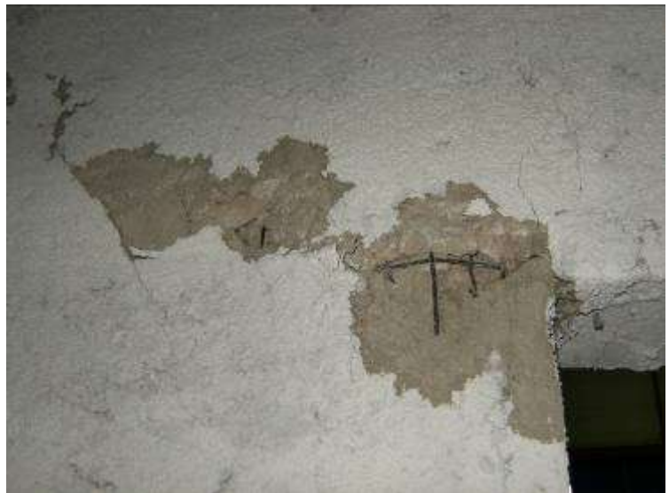
Figura 78 Danneggiamento al termine dell'imposizione dei tre cicli a livello di drift 1.0% (quadro globale e danneggiamento in corrispondenza degli spigoli della porta)
