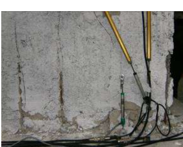
Figura 81 Danneggiamento al termine dell'imposizione di un ciclo di carico e scarico a livello di drift 1.5% (alla base del muro)
