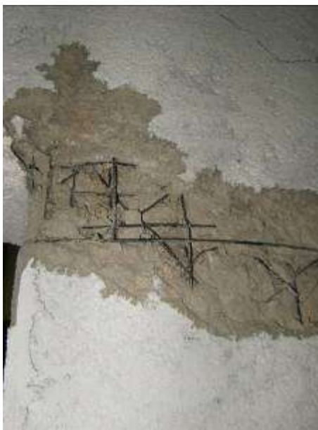
Figura 78 Danneggiamento al termine dell'imposizione dei tre cicli a livello di drift 1.0% (quadro globale e danneggiamento in corrispondenza degli spigoli della porta)
