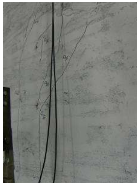
Figura 48 Danneggiamento al termine dell'imposizione dei tre cicli a livello di drift 0.4%
