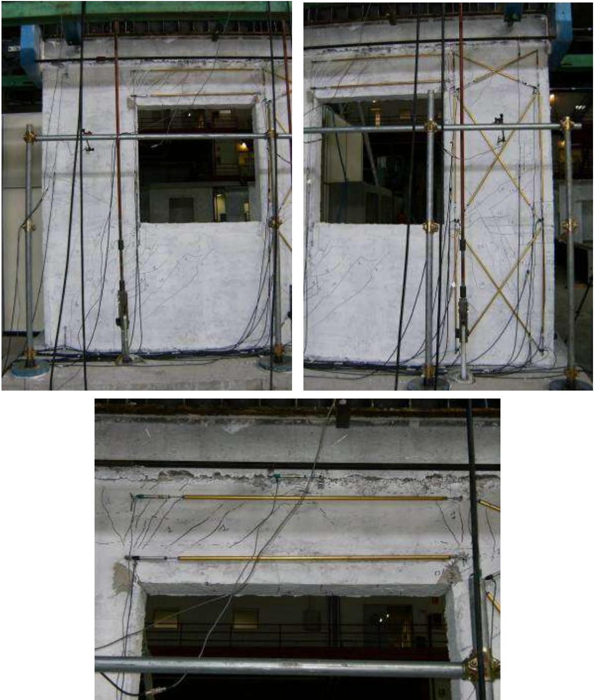
Figura 51 Danneggiamento al termine della fase di carico e scarico a drift massimo 1.5%
