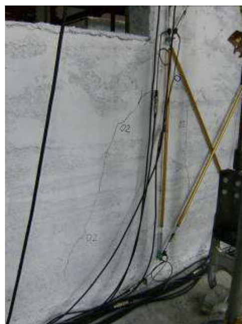
Figura 54 Danneggiamento al termine dell'imposizione dei tre cicli a livello di drift 0.2%
