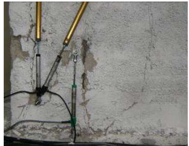
Figura 81 Danneggiamento al termine dell'imposizione di un ciclo di carico e scarico a livello di drift 1.5% (alla base del muro)
