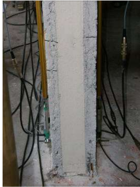
Figura 13 Danneggiamento al termine dell'imposizione dei tre cicli a livello di drift 0.4%
