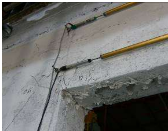
Figura 56 Danneggiamento al termine dell'imposizione dei tre cicli a livello di drift 0.6%
