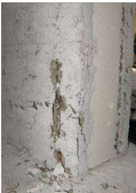
Figura 55 Danneggiamento al termine dell'imposizione dei tre cicli a livello di drift 0.4%
