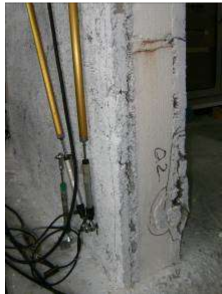
Figura 75 Danneggiamento al termine dell'imposizione dei tre cicli a livello di drift 0.2%
