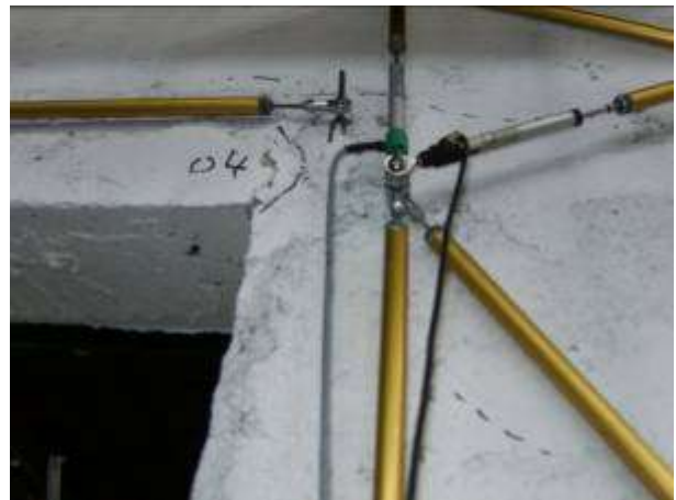
Figura 47 Danneggiamento al termine dell'imposizione dei tre cicli a livello di drift 0.2%
