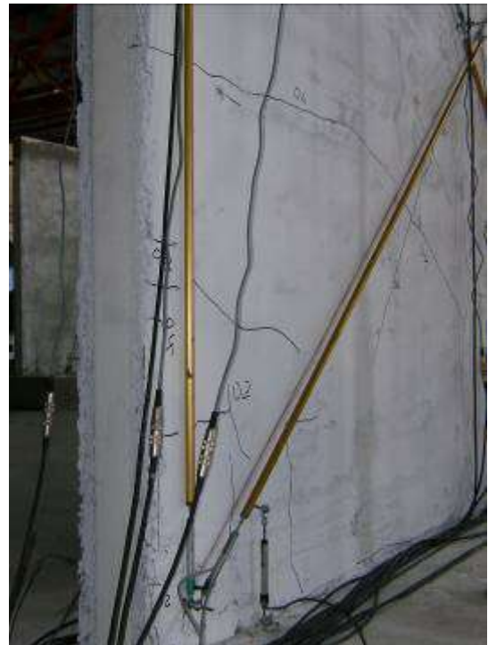
Figura 21 Danneggiamento al termine dell'imposizione dei tre cicli a livello di drift 0.4%
