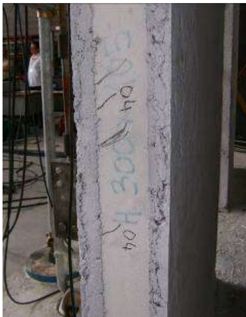
Figura 66 Danneggiamento al termine dell'imposizione dei tre cicli a livello di drift 0.4%
