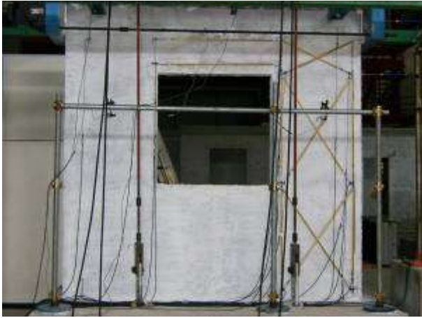
Figura 47 Danneggiamento al termine dell'imposizione dei tre cicli a livello di drift 0.2%
