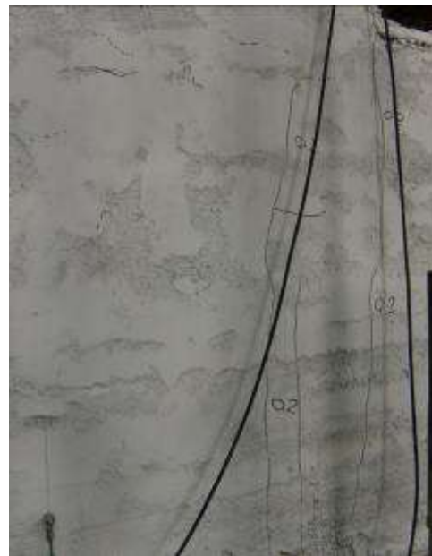
Figura 53 Danneggiamento al termine dell'imposizione dei tre cicli a livello di drift 0.1%
