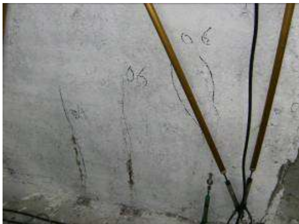
Figura 77 Danneggiamento al termine dell'imposizione dei tre cicli a livello di drift 0.6%
