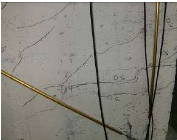
Figura 32 Danneggiamento al termine dell'imposizione dei tre cicli a livello di drift 0.4%
