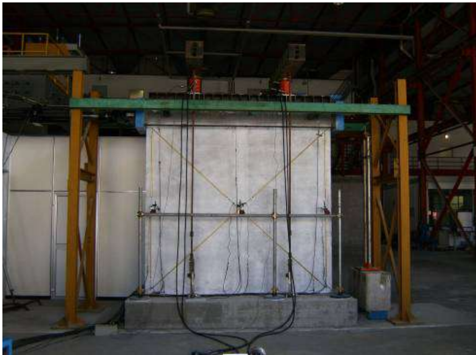
Figura 3 Configurazione di prova di un pannello senza aperture
