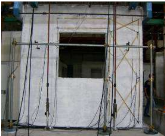
Figura 47 Danneggiamento al termine dell'imposizione dei tre cicli a livello di drift 0.2%
