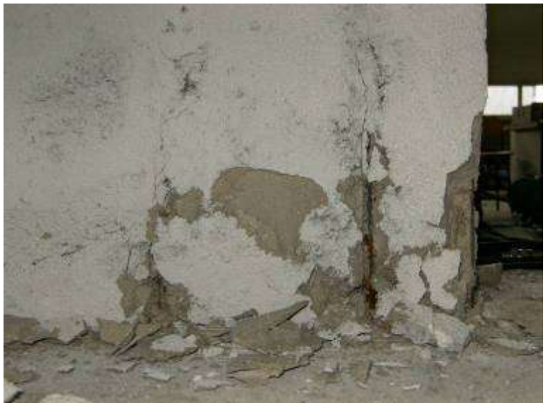
Figura 80 Danneggiamento al termine dell'imposizione di un ciclo di carico e scarico a livello di drift 1.5% (quadro generale e danneggiamento in corrispondenza degli spigoli della porta)
