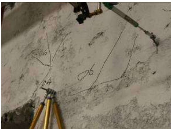
Figura 67 Danneggiamento al termine dell'imposizione dei tre cicli a livello di drift 0.6%
