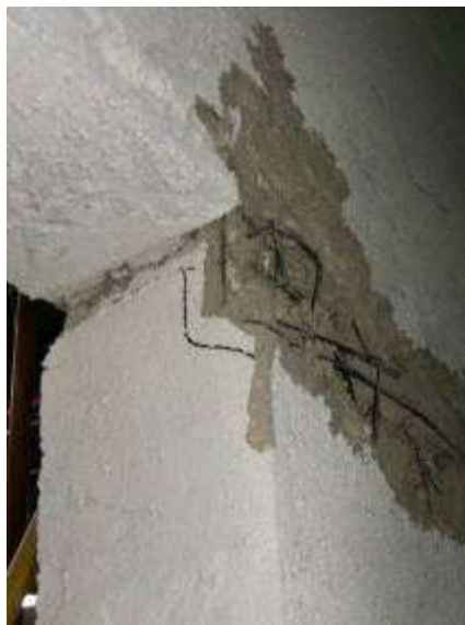
Figura 80 Danneggiamento al termine dell'imposizione di un ciclo di carico e scarico a livello di drift 1.5% (quadro generale e danneggiamento in corrispondenza degli spigoli della porta)
