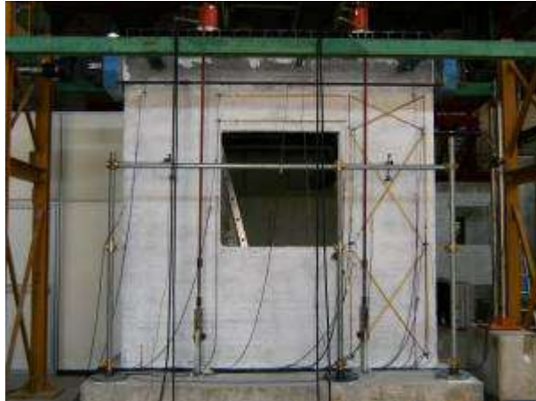
Figura 53 Danneggiamento al termine dell'imposizione dei tre cicli a livello di drift 0.1%
