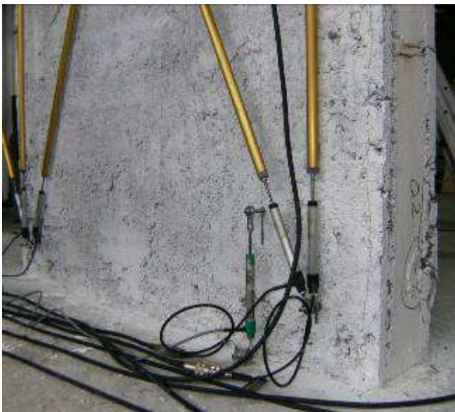
Figura 75 Danneggiamento al termine dell'imposizione dei tre cicli a livello di drift 0.2%
